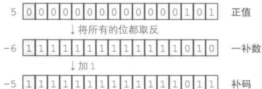
图 5C-1 由正值转换到补码表示的负值
