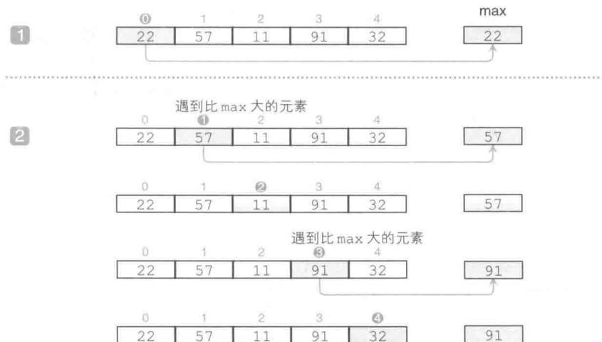
图 6-7 计算数组中元素最大值的步骤
